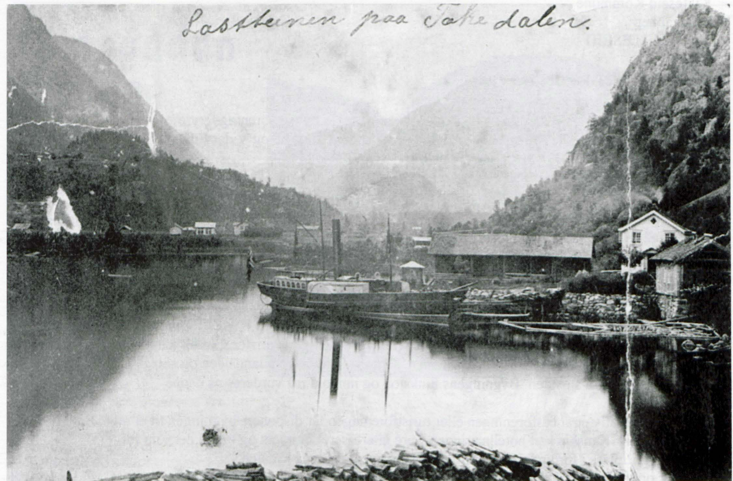
St. Olaf - den første dampbåten på Vesttelemarksvannene, som gikk mellom Strengen og Dalen. De første dampskipene hadde fasong som seilskip med bl. a. den karakteristiske clipperbaugen. Foto av Knut Berdal, Vinje.
