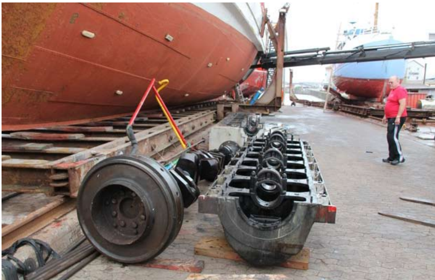
B &W Alpha 406 FLO 1952 med ødelagt veivaksel på kaien.
