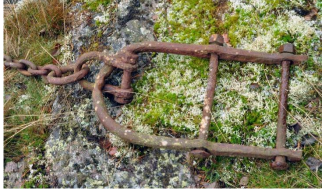
Klaven til lensa som var forbundet med strammespiilet. Foto: Telemark Museum.
